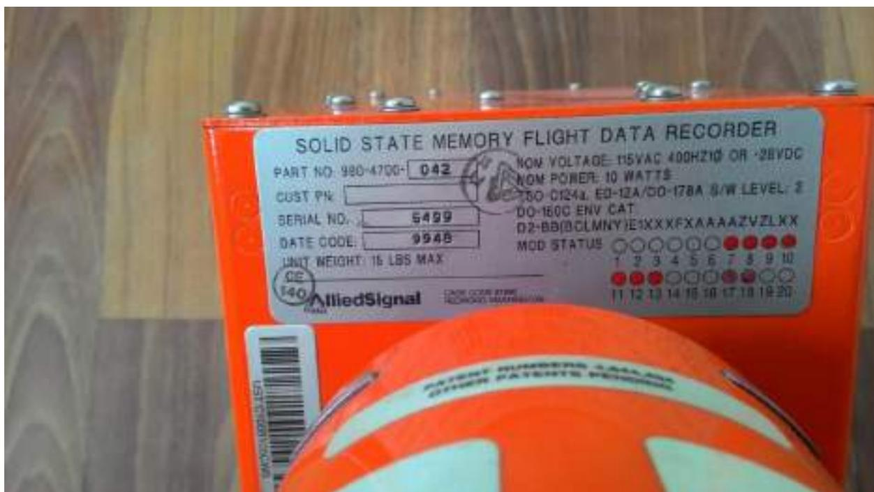
Рисунок 11 Шильдик с данными FDR
