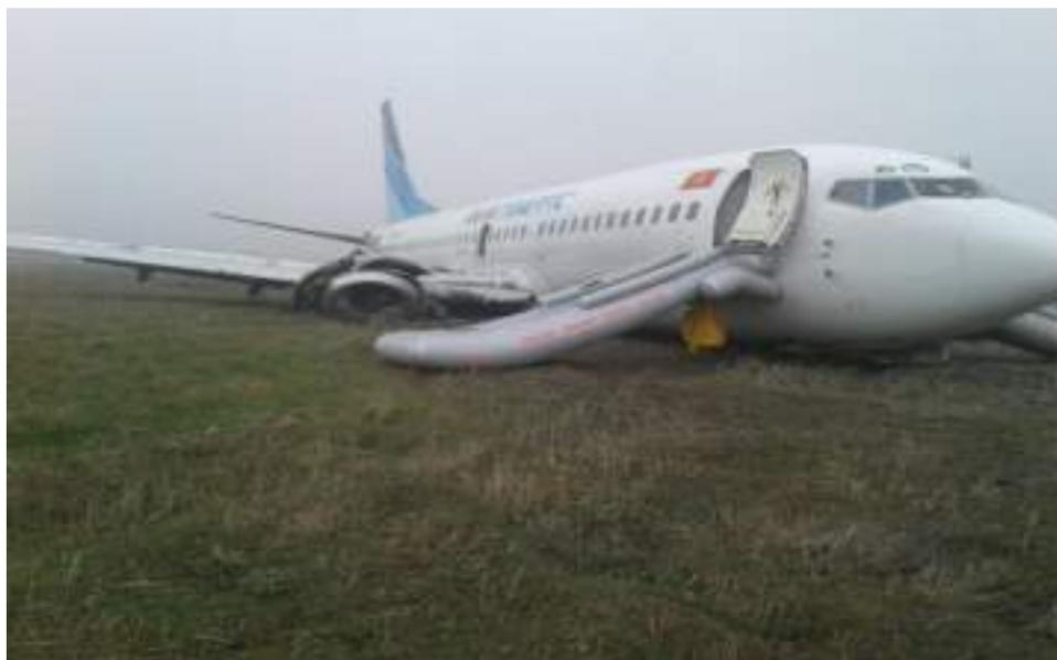
**Рисунок 37 Использование аварийных трапов для эвакуации пассажиров**
