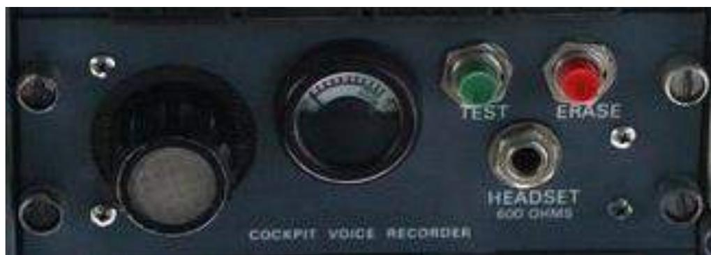
Рисунок 38 Панель управления магнитофоном
