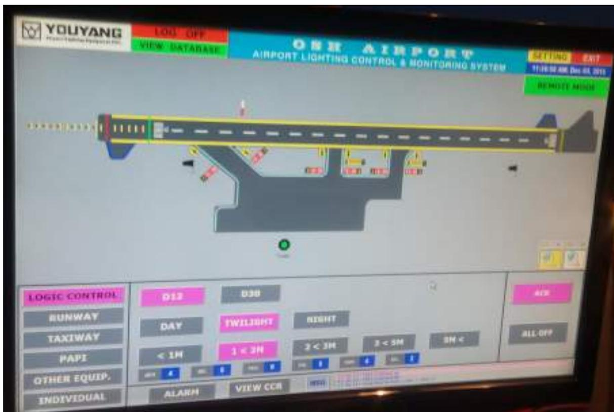
Рисунок 59 Изображение светосистемы на мониторе диспетчера СДП при полном включении боковых огней ВПП
