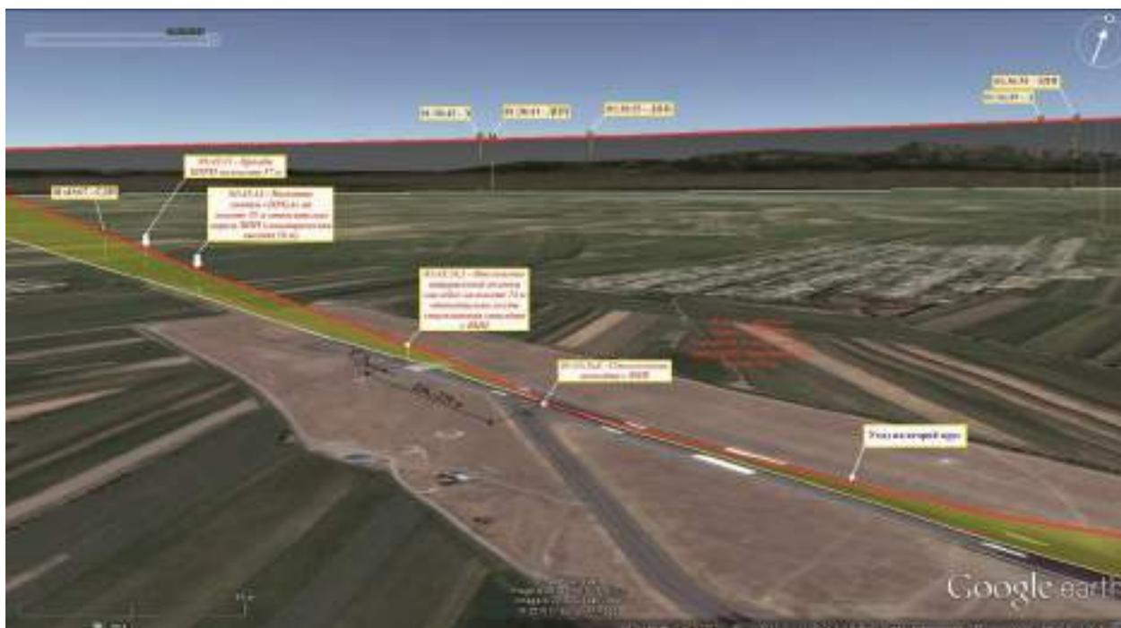
Рисунок 45 Пространственная траектория на конечном участке захода и при уходе на второй круг
