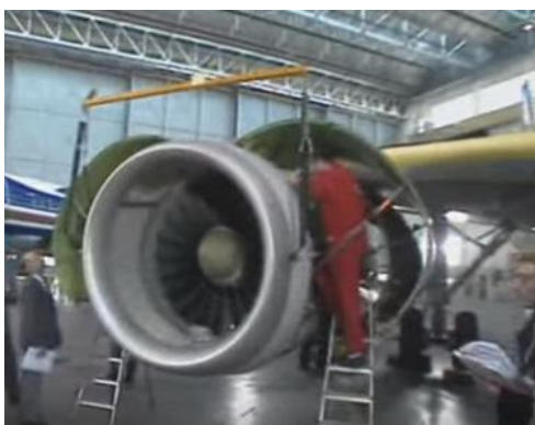
Fase di smontaggio di una air inlet cowl
