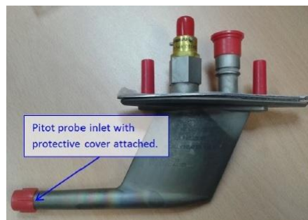
Immagine tratta dalla pagina 9 del rapporto ATSB; in essa si vede una sonda con la relativa copertura di protezione
