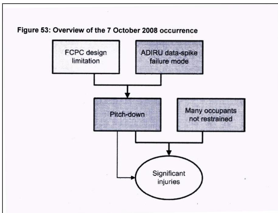
Scendendo nel dettaglio (5.2.1) il rapporto annota come l'AOA sia un parametro di volo “*critically important*”, e un aeromobile con un “*full-authority flight control system*” quale è appunto l'A330 e 340 deve essere progettato in modo tale da disporre e usare accurati dati AOA. Ora, prosegue il rapporto, lo strumento
