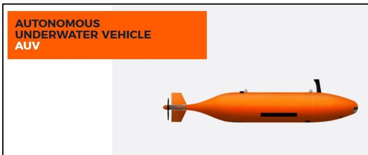
Gli AUVs sono equipaggiati con sofisticate apparecchiature tipo sonar, multi-beam echosounder, sub-bottom profiler, HD camera, conductivity/temperature/depth sensor, self-compensating magnetometer, synthetic aperture sonar e sensori di torbidità.
