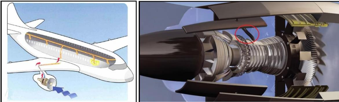
*A sinistra: l'aria viene catturata dai motori ed entra in circolo; A destra: il complesso meccanismo del motore composto da vari rotori; basta una minima perdita di lubrificante sempre presente fra i vari rotori per far circolare aria contaminata che entra in cabina tramite quel bypass da noi evidenziato in rosso.*
