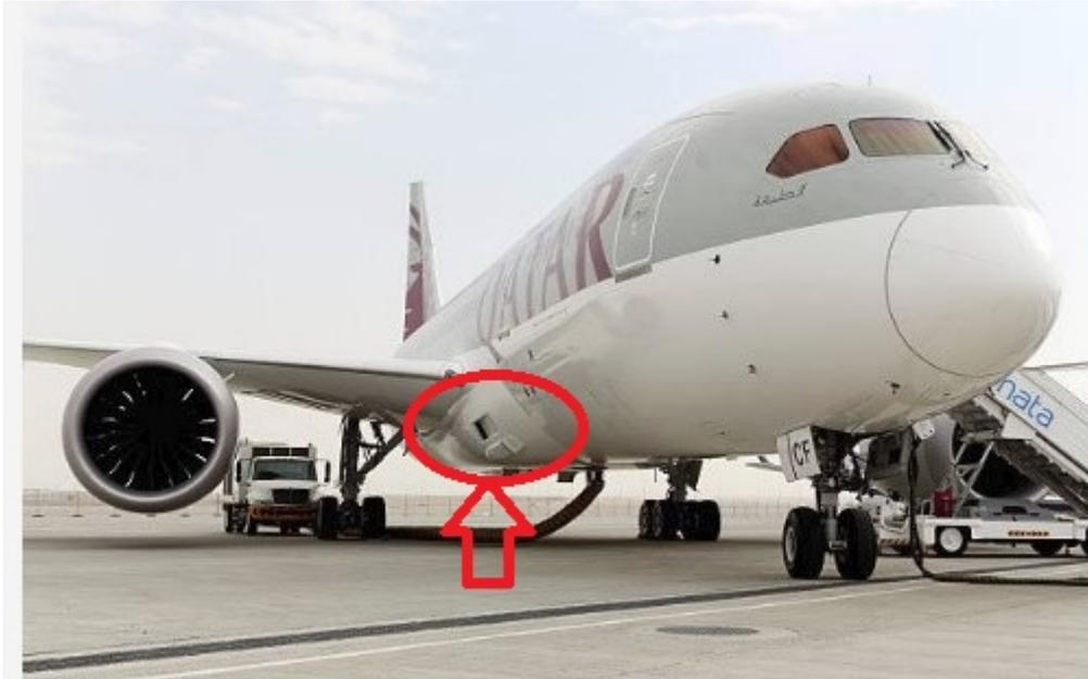
*Il Boeing 787 è attualmente l'unico velivolo nel quale il prelievo dell'aria non avviene tramite i motori bensì da apposite prese. Su questo aereo incidenti dovuti a fumi tossici, per perdite di lubrificanti nei motori, non si possono verificare.*
