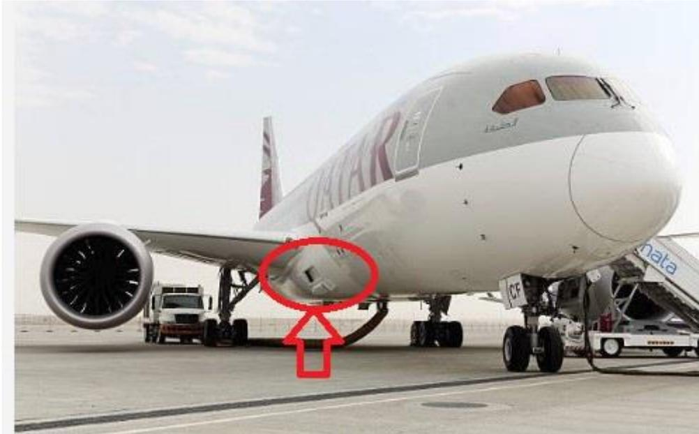
*Il Boeing 787 è attualmente l'unico velivolo nel quale il prelievo dell'aria non avviene tramite i motori bensì da apposite prese. Su questo aereo incidenti dovuti a fumi tossici, per perdite di lubrificanti nei motori, non si possono verificare.*
