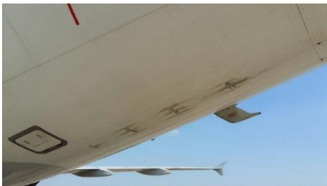
Foto 1: danneggiamenti sulla parte posteriore-inferiore della fusoliera dell'aeromobile A320 marche EI-DTB.
