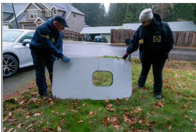
Il portellone "saltato" dalla fusoliera del 737 di Alaska Airlines, recuperato nei pressi della città di Portland
