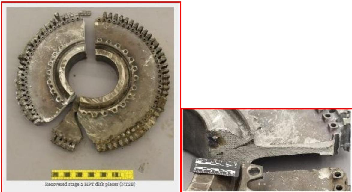
Un disco della turbina (stage 2 high pressure) si è rotto in più parti. Una parte è finita per colpire la facciata di un magazzino aeroportuale della UPS, una nell'ala, altra nella fusoliera.
