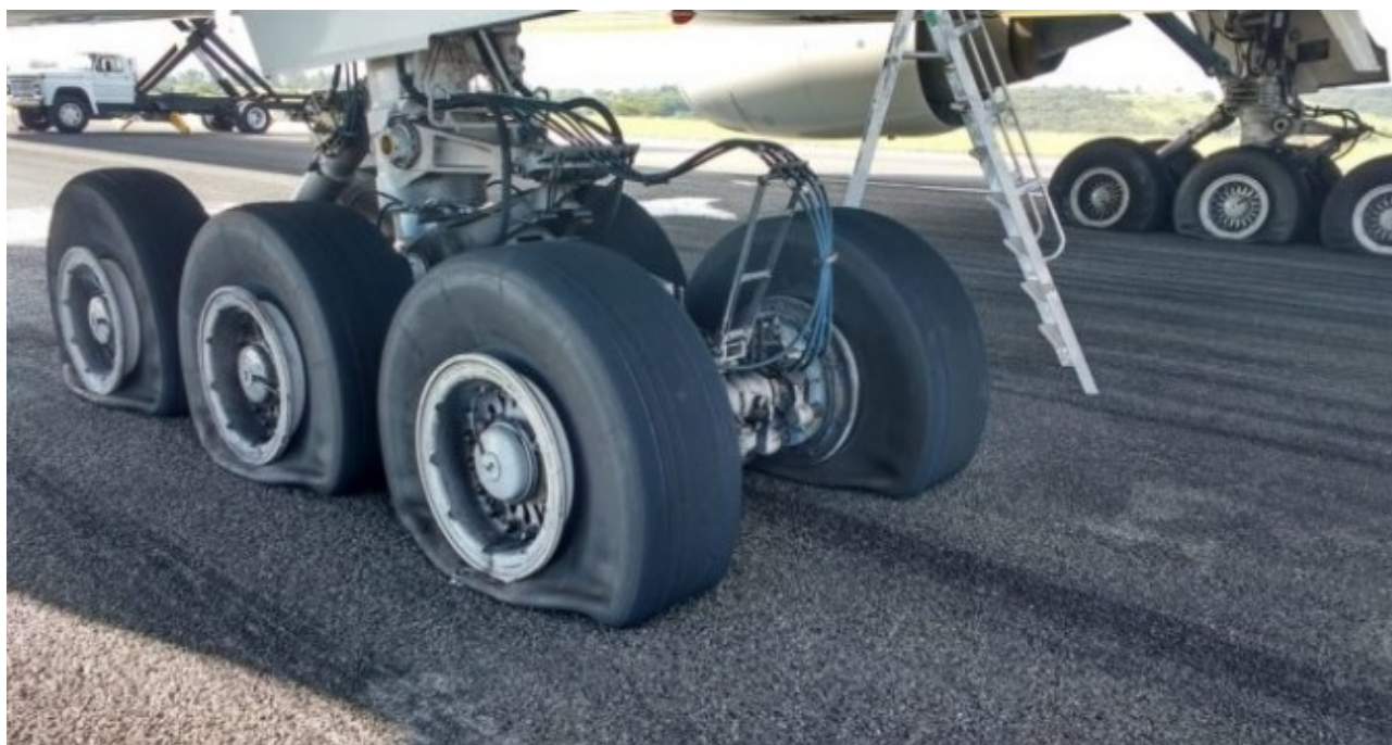
Così erano ridotte le 12 ruote del carrello principale dopo l'atterraggio a Belo Horizonte
