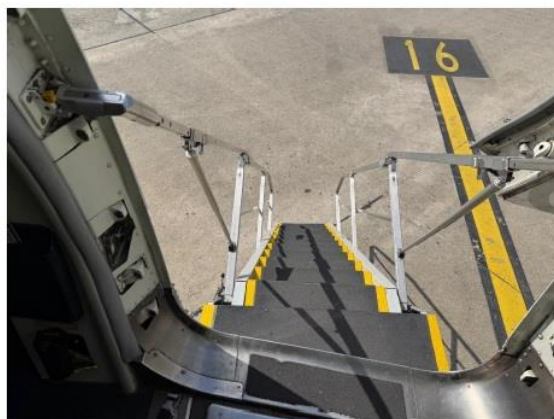
Foto 5: vista dall'interno della cabina della scala integrata del B737. Si noti il primo gradino asimmetrico per la discesa del passeggero.
